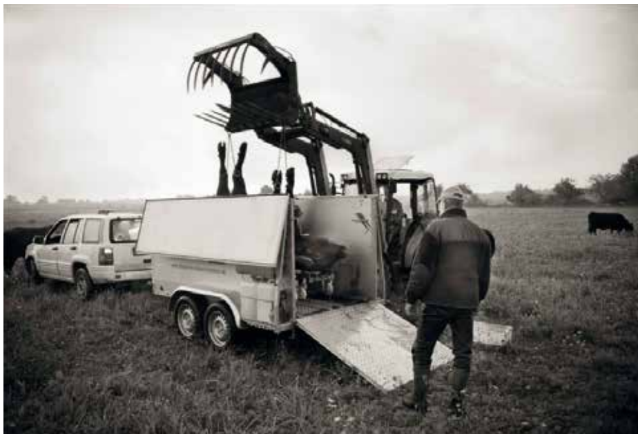
CAISSON LEA TRAMPENAU : L'UTILISATION DE CE CAISSON NÉCESSITE LE RECOURS AU MATÉRIEL DÉTENU PAR L'ÉLEVÉUR : LE TRACTEUR ET LA FOURCHE DU TRACTEUR POUR ASSURER LA LEVÉE DE L'ANIMAL ET LE MATÉRIEL D'IMMOBILISATION DE L'ÉLEVAGE.
