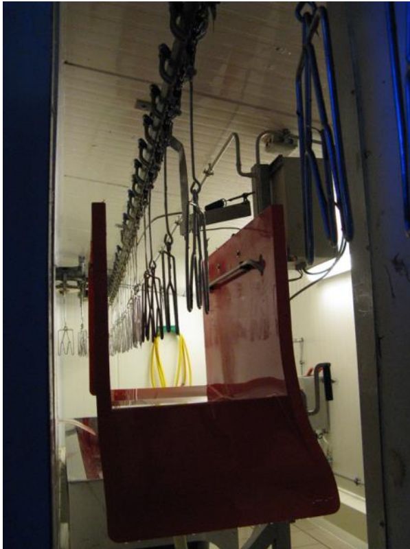
Abattoir de Sclayn, abattage de volailles par electronarcose (bain électrifié)
